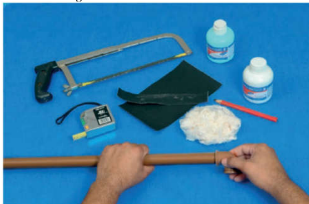
Figura 6. Encaixe das extremidades
